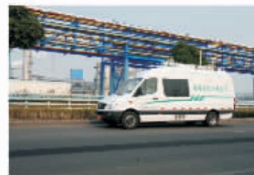
国内首台投入使用的毫秒级在线质谱环境流动监测车走出厂区实时环保巡查
