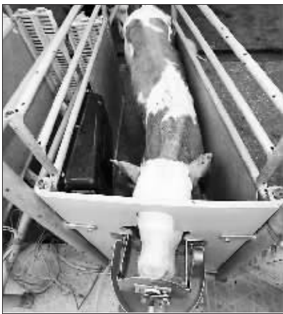
日前,新疆昌吉郎青牧场犏牛饲养机器人正在给犏牛喂食。该牧场引进利拉伐犏牛饲喂机器人,掀起犏牛饲养的技术革命。 该系统提供自动断奶程序,监控犏牛采食情况,提供报警、历史数据和统计分析,以保证犏牛采食按时、定量和定温合理搭配饮食。 张秀科/CFP
