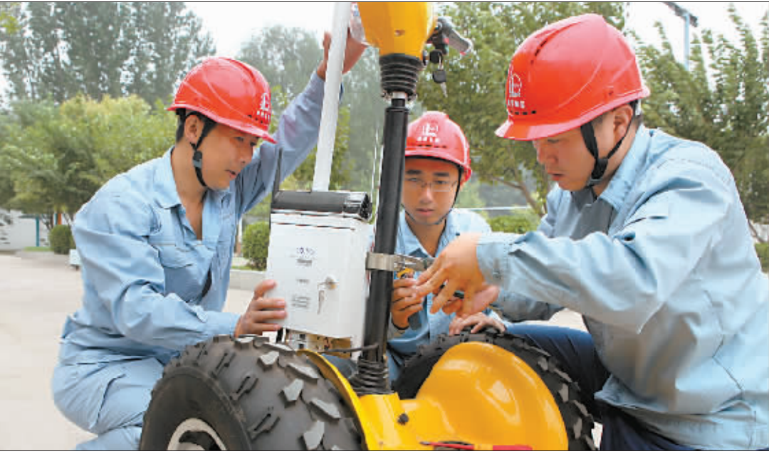
中石化管道新乡输油处青年员工在数字化管道改造过程中,积极开展“五小”活动,解决了许多老管道在数字化运行中出现的新老设备兼容难题。图为滑县站青工利用管道数字化无线网络后台,开发研制了多功能视频巡检车,保证了运行30年的老管道在数字化新模式运行下的安全管理。
