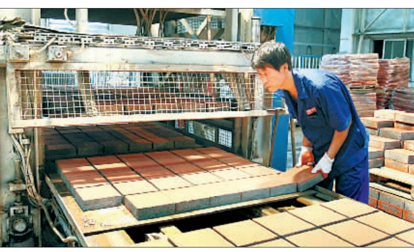
为维护“北京后花园”生态环境,助推河北省经济发展“绿色崛起”,承德市双滦区已完成44座尾矿库的实地再测算,尾矿综合利用产业体系已初步形成,项目全部投产后年可利用铁尾矿432万吨,废钢渣13万吨,粉煤灰92万吨,高炉水渣30万吨。图为企业在用矿渣生产透水砖。白子军 摄
