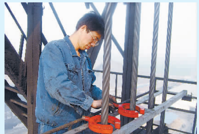
2008年2月21日,游弋在车集煤矿主井天轮安装自己研发设计的全自动除尘环。
