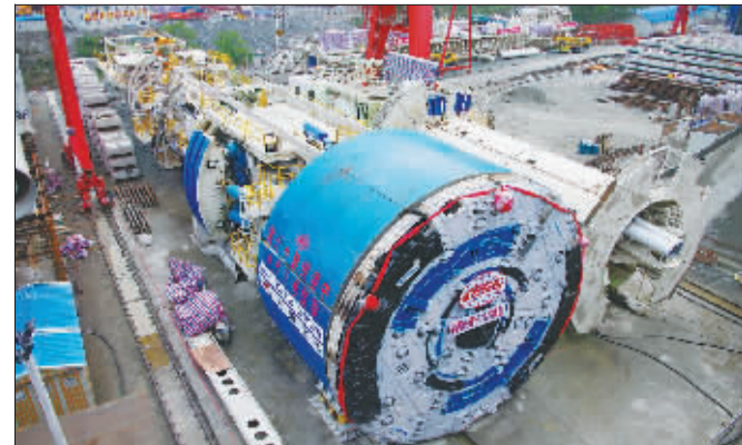
中铁十八局集团用于兰渝铁路西秦岭隧道施工的TBM
