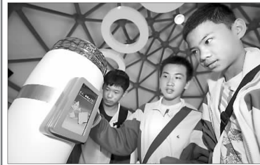
一个普通的杯子,配上传感器和芯片之后会怎样?广州中学生郭钧(中)把手搭上杯子3秒之后,杯身上的液晶屏就告诉他,今天应该喝多少水(5月2日报)。原来,当杯子通过传感器感知到体温,并综合环境因素后,它就能给出建议了。
