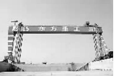
3月10日,我国最大的龙门起重机诞生。该起重机跨度为230米,为国内最大跨度,标准载重为900吨,实际载重可以达到1500吨,由武桥重工集团总承包制造并安装完成。
