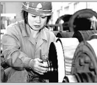
质检员庞秋霞是新乡机务段唯一的女电器技师,她在对内燃机车牵引电机的检查、验收中跟踪控制检修过程,采取“摸配件装配,听实验声音、闻异常气味、看实验数据、对技术规定”的招数,改变了以前只控制结果而不注重过程的检查、验收方式,彻底消除了故障隐患。此作业法获该段科技成果创新奖,并被命名为“庞氏牵引电机检查法”。仅10月份,她运用该法就检查出牵引电机故障隐患86件。
